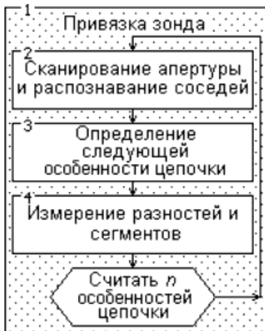
Рис. 3. Упрощённая блок-схема алгоритма ООС. Процедура привязки зонда работает в фоновом режиме. Сканирование считается законченным, если длина цепочки достигла заданного значения n .
