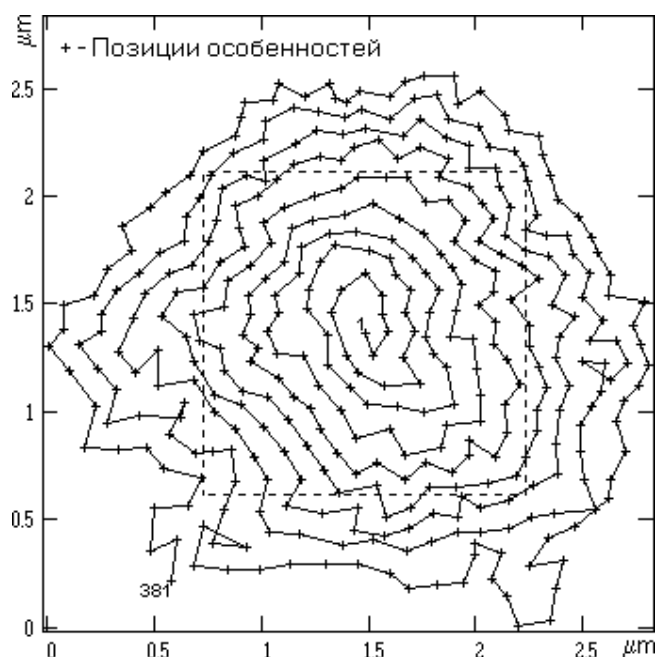
Рис. 7. “Паутина” – траектория “перемещения зонда” от одной особенности к другой в процессе построения цепи. Пунктирной линией показаны границы заполняемого окна.
